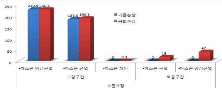
교면포장 손상별 비교표
